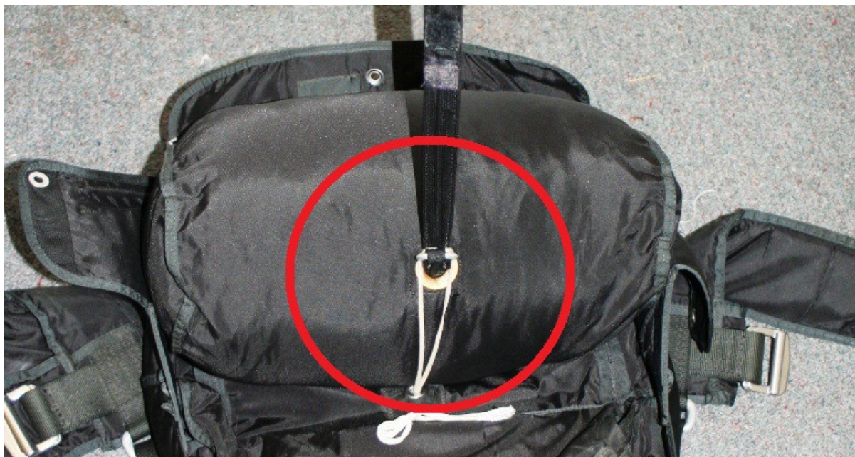
Слика 8. Граничник контејнера захваћен инсталираним конопцем (блокада изласка)
